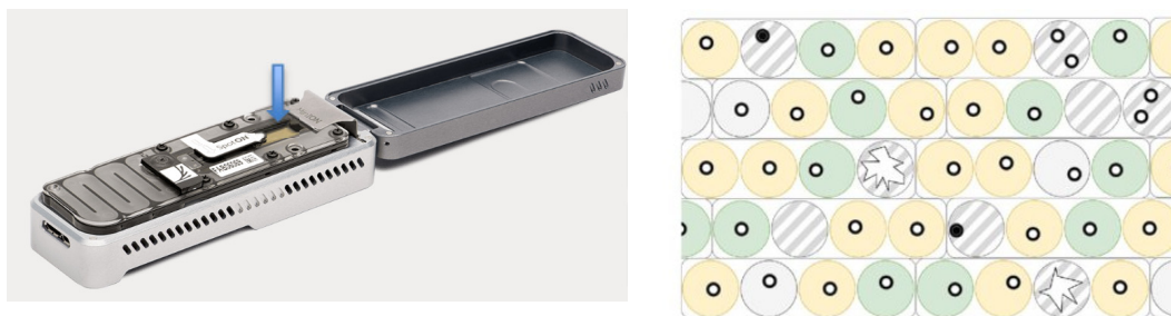
Abbildung 4: FlowCell in einem MinION (A) und Schema der Nanoporenverteilung (de Lannoy, de Ridder et al. 2017). (A) zeigt die FlowCell im MinION, Der Bereich, in dem die DNA Sequenzierung abläuft, ist mit einem Pfeil markiert. (B) zeigt die Anordnung der Nanoporen; die größeren bunten Kreise sind die Wells in denen sich die Nanoporen befinden (kleine Kreise). Nur Wells die intakt sind und nur eine Nanopore enthalten, sind funktionsfähig.
